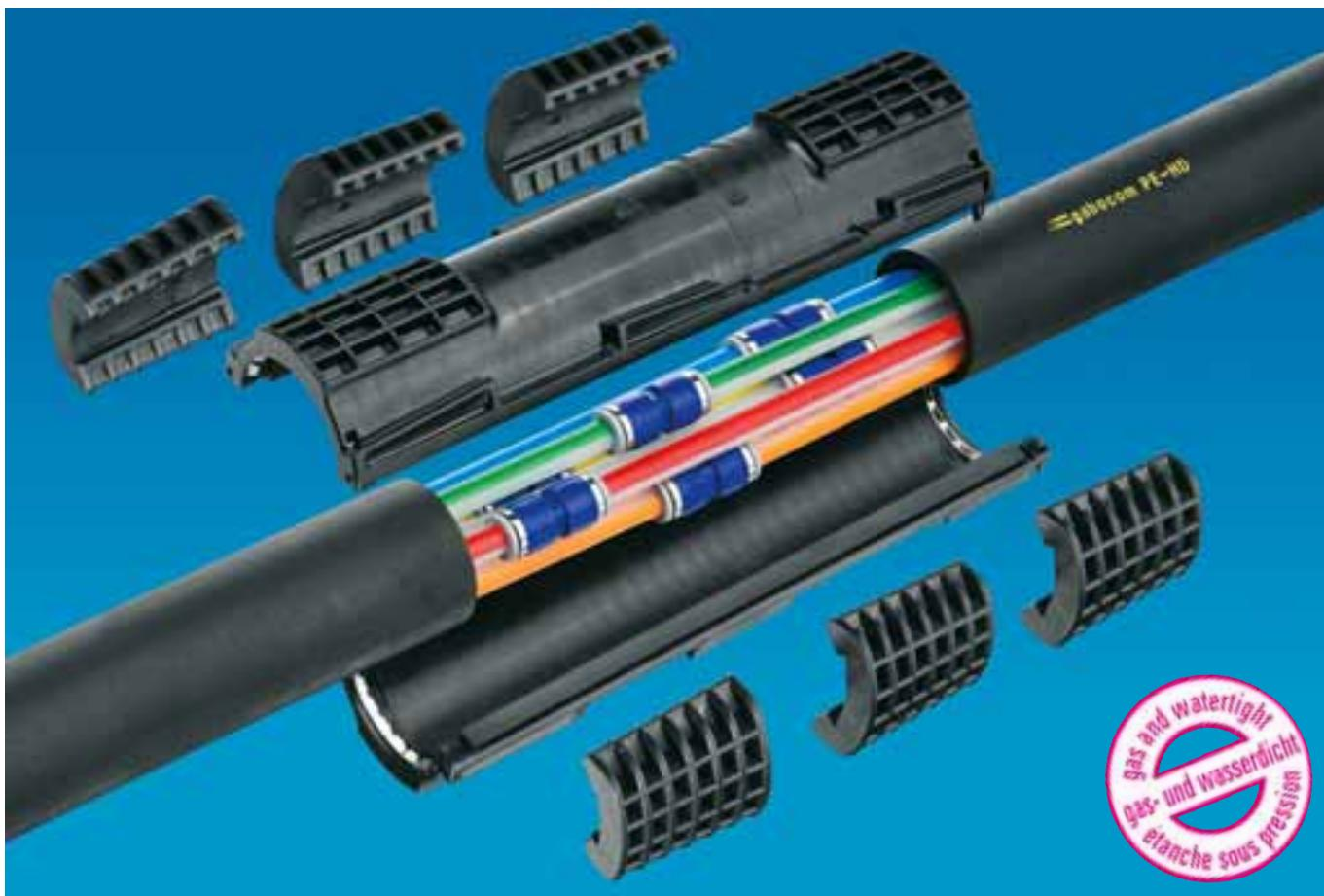
Reparurmuffe zum Verschließen von PE-HD-Rohren Ø 50, geeignet zur Aufnahme von 7 speed•pipe® Ø 10 mit DSM 10 oder von 14 speed•pipe® Ø 7 mit DSM 7. Beim Verbinden belegter speed•pipe® durch EBM 10 können 7 speed•pipe® Ø 10 und davon bis zu 2 mit EBM 10 aufgenommen werden. Gas- und wasserdicht bis 0,5 bar. Zugfest bis 1500 N.
