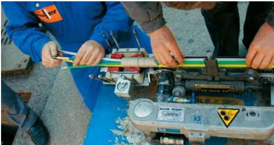
gabocom-speed•pipe® beim Einlegen in den super jet und beim Anbringen der Ventilkappen am speed•pipe®-Anfang.
