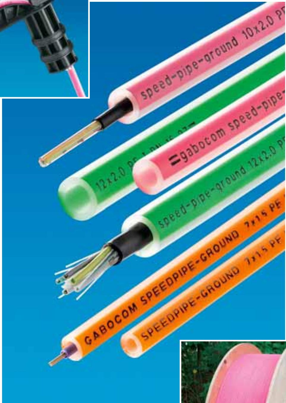
**Der minimale Biegeradius** für speed●pipe®-ground Ø 10 (7, 12) mm liegt bei R = 60 mm bei unterstützter Biegung und bei R = 100 (70, 120) mm bei freier Biegung.
