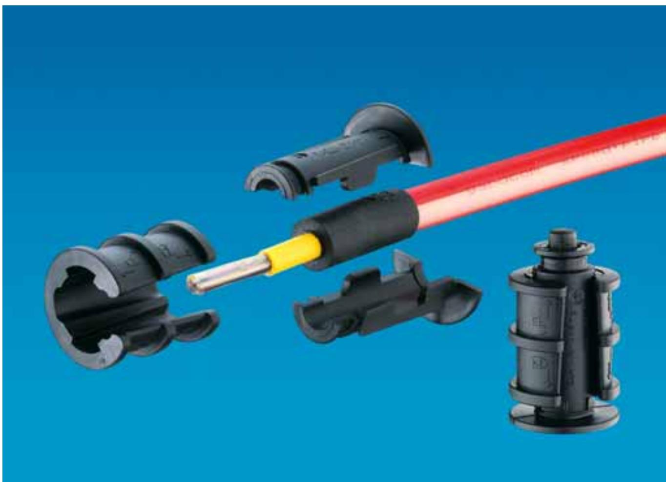
Wiederverwendbare Einzelzugabdichtung, teilbar, zum Abdichten von belegten und unbelegten speed•pipe®, dicht gegen Gas und Wasser bis 0,5 bar.
